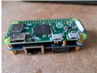
3. Die Baugruppe ins Gehäuse einbauen (mit den HUB nach unten), verschrauben, Deckel drauf 😊
