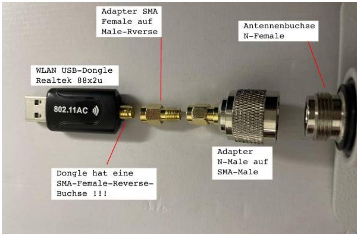
Hier sind die verwendeten Elemente zwischen dem USB-Kabel und der Antenne zu sehen. Leider haben alle USB-WLAN-Dongle mit abnehmbarer Antenne eine SMA-Female-Reverse-Buchse verbaut, so dass leider ein zusätzlicher Adapter notwendig ist. Sollte zwar vermieden werden, aber geht leider nicht anders. Das Ganze wird mit einem Kunst-Stoff-Installationsrohr aus dem Baumarkt sowie selbstverschweissem Isolierband gegen Wind, Wetter und nestbauende Insekten geschützt.
